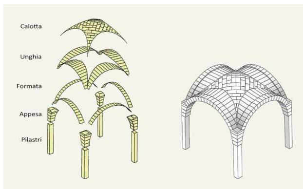
Figura 3. Schema di volta a spigolo o "a stella" a 4 punte. Tratto dal testo "Le volte leccesi tra tradizione e innovazione" di E. Arlati e L. Accoto.
