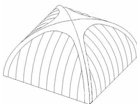
Figura 6. Schema di una volta a padiglione, nota localmete come volta "a carrozza".
