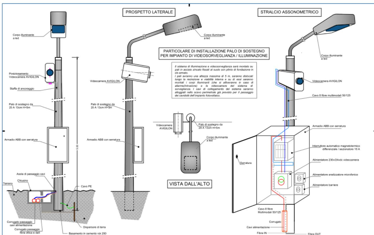
Figura 3 Tipologia palo da installare
