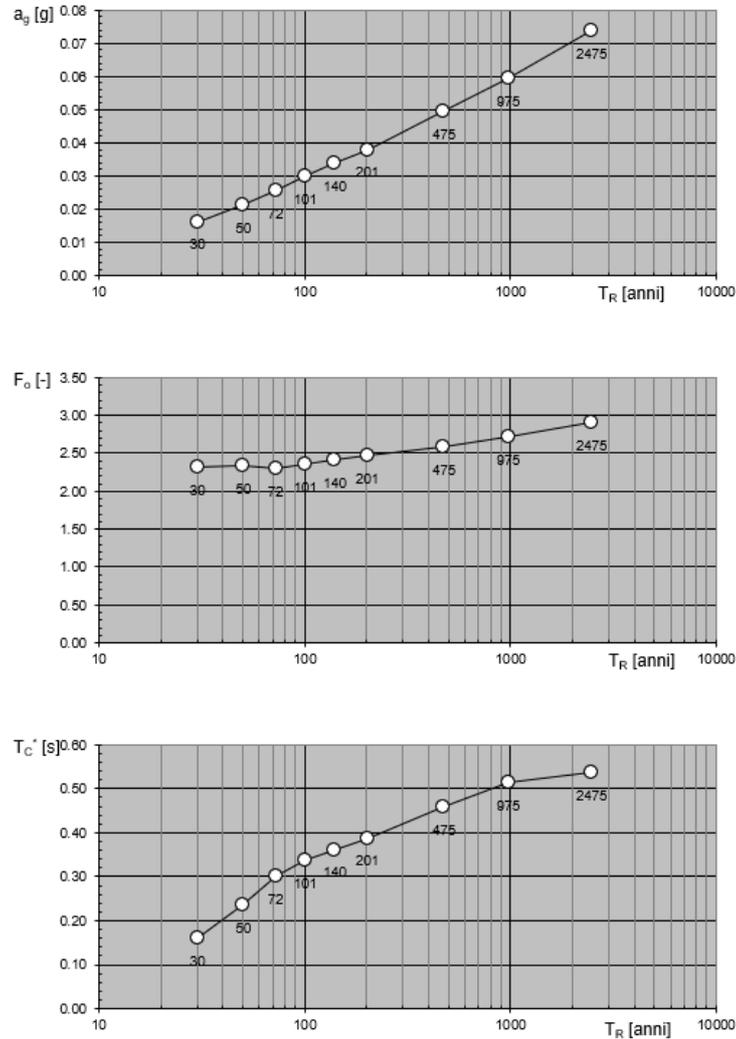
Fig. 5.6 Variabilità parametri sismici con periodo di ritorno
