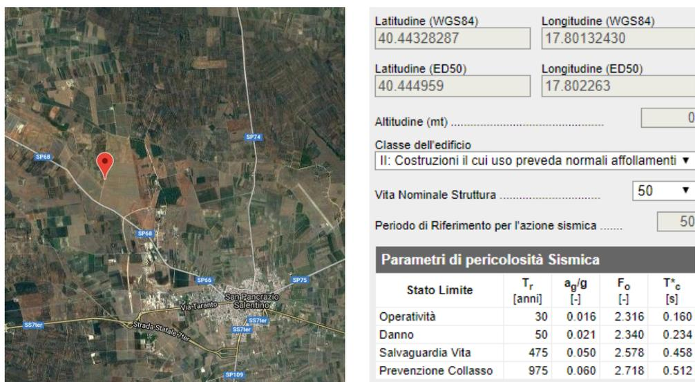
Fig. 5.4 Parametri di pericolosità sismica dell'area in esame
