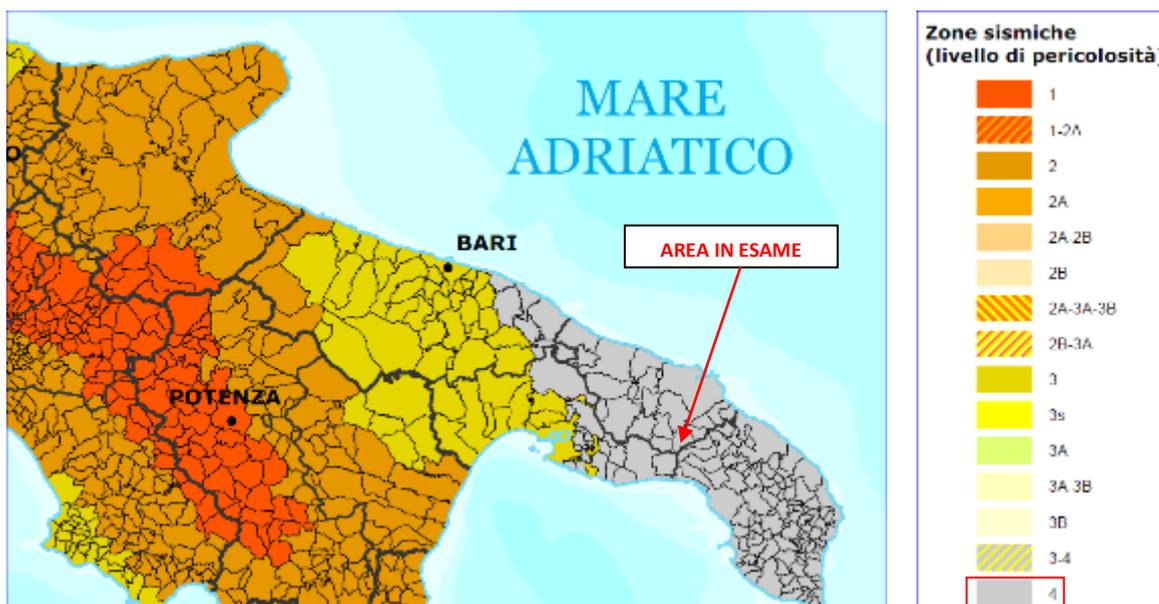
Fig. 5.1 Classificazione sismica 2010 - Ordinanza PCM 3274 del 20 marzo 2003
