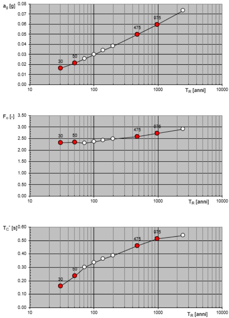
Fig. 5.9 Variabilità parametri sismici con periodo di ritorno
