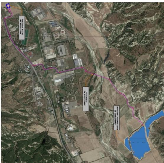
Figura 1. Localizzazione dell'area di impianto, del percorso cavidotto e della Cabina di elevazione MT/AT
