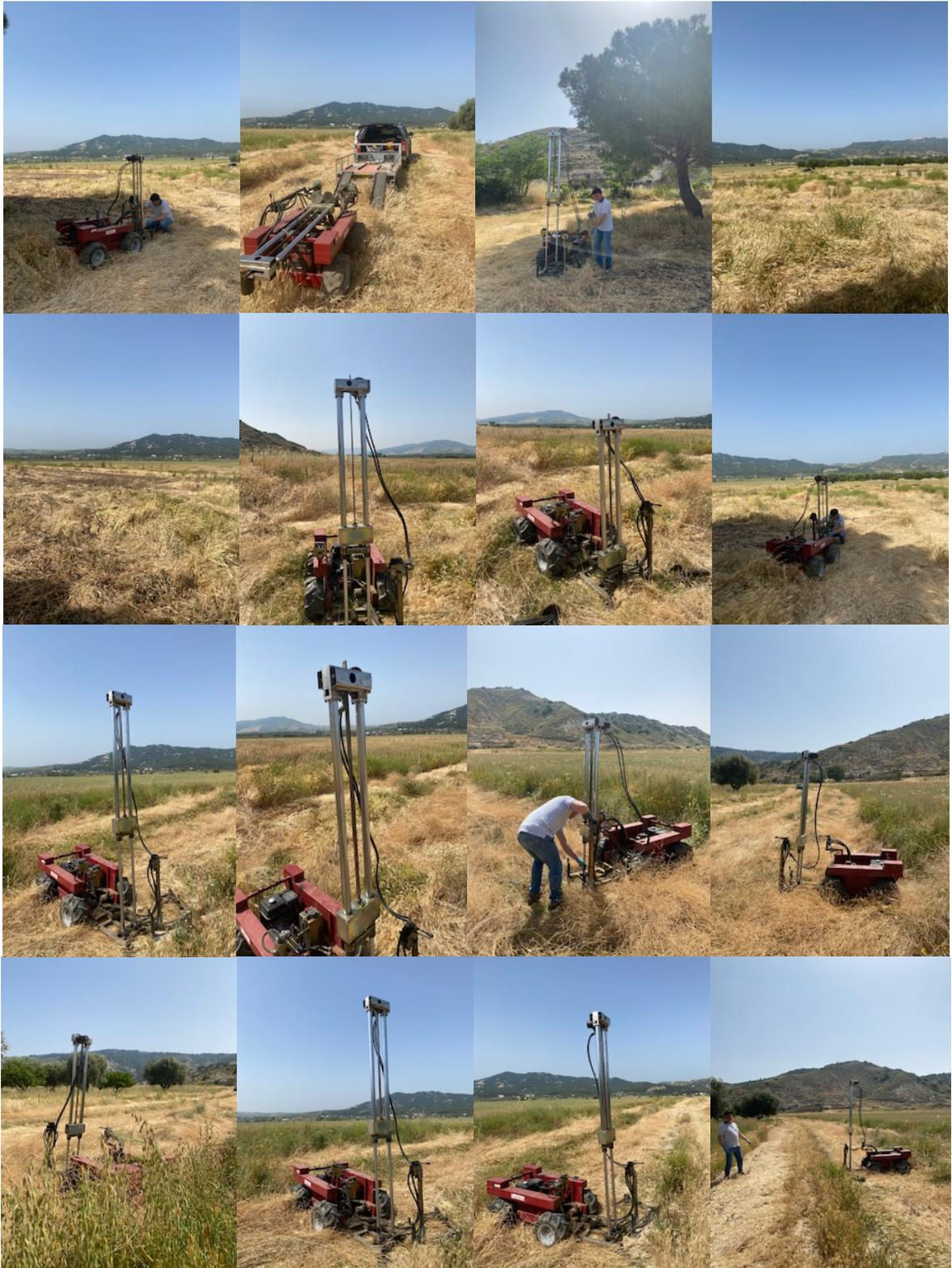
**PROVA PENETROMETRICA DINAMICA**
