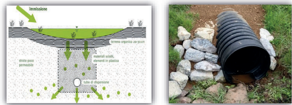
Figura 38 - Tipici sistemi di drenaggio
