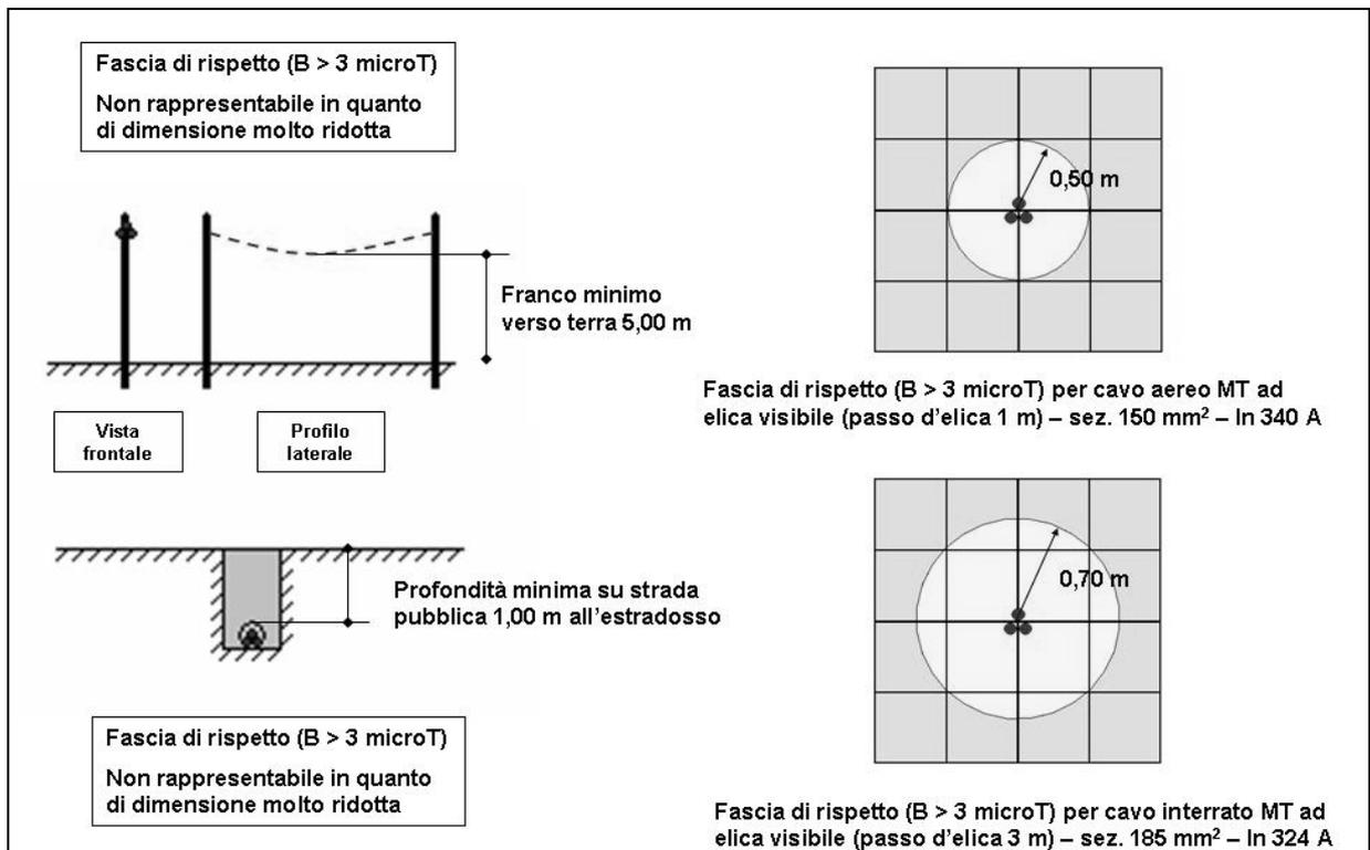
Figura 1 – Curve di livello dell'induzione magnetica generata da cavi cordati ad elica – calcoli effettuati con il modello tridimensionale “Elico” della piattaforma “EMF Tools”, che tiene conto del passo d'elica.
