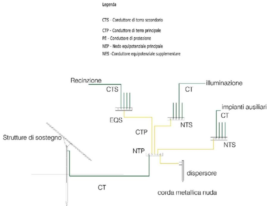
Il sistema di protezione adottato è quello dell'interruzione automatica dell'alimentazione in caso di guasto a terra pericoloso, attraverso un idoneo impianto di terra coordinato con differenziali.
