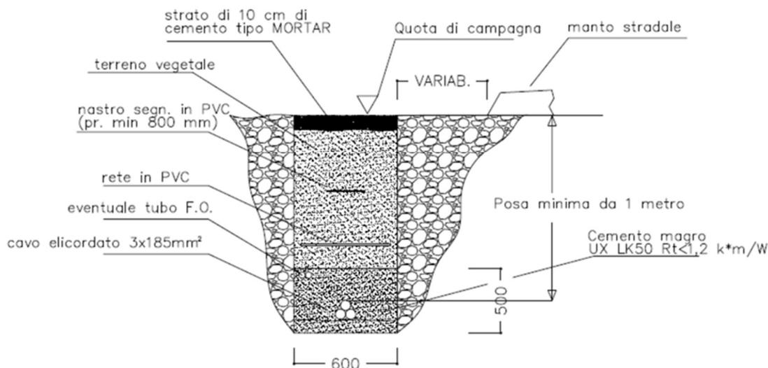
Il cavidotto interrato sarà eseguito in scavo a sezione ristretta della larghezza di 80 cm.
