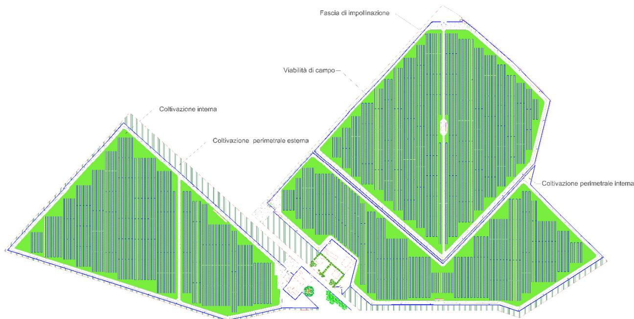
La potenza elettrica DC complessiva dell'impianto agrovoltaico "BUILLI" è pari a 16,564,80 MWp mentre la potenza elettrica AC complessiva è pari a 14,25 MWn.
