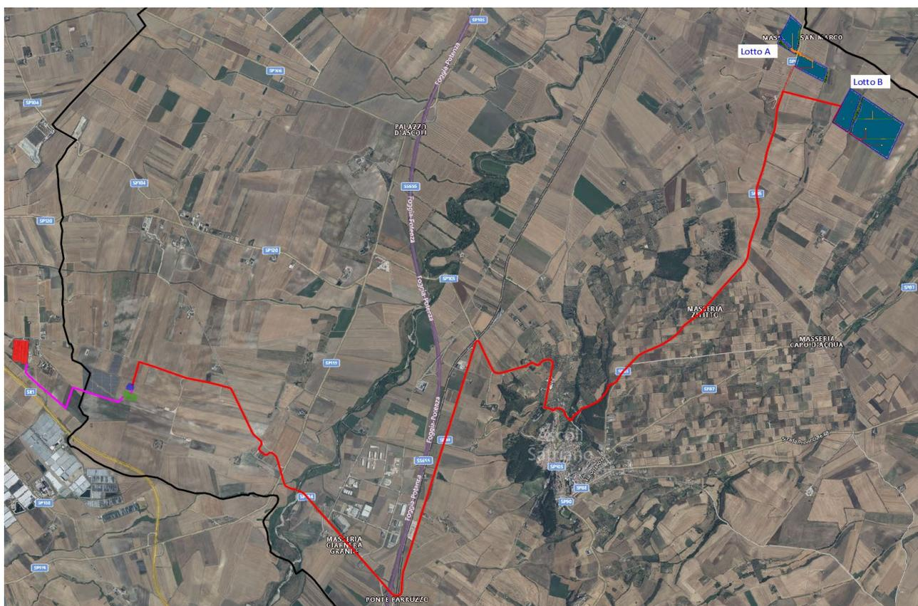
*Figura 34. Layout impianto e collegamento con SSE su ortofoto*
