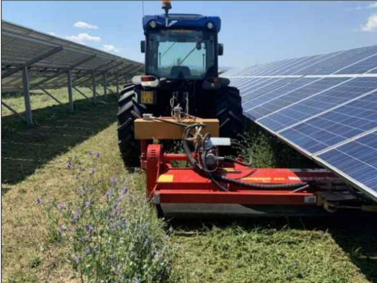
**Figura 12** Trinciatura del cotico erboso con barra falciante
