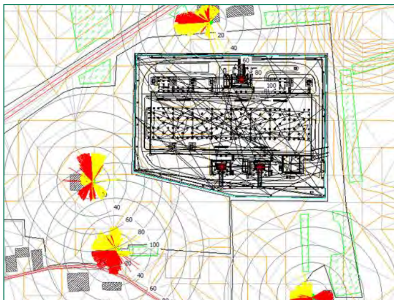
Figura 15: Specifica dell'applicazione della tecnica di calcolo a tracciamento di raggi (ray-tracing)
