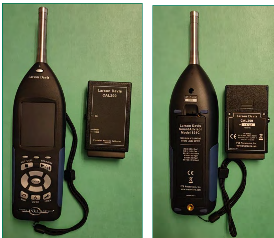
Figura 13: Strumentazione utilizzata per indagine acustica; fonometro e calibratore.
