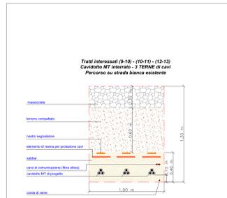
Particolare della sezione trasversale - Scala 1:20
