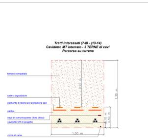
Particolare della sezione trasversale - Scala 1:20
