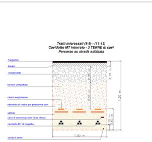
Particolare della sezione trasversale - Scala 1:20
