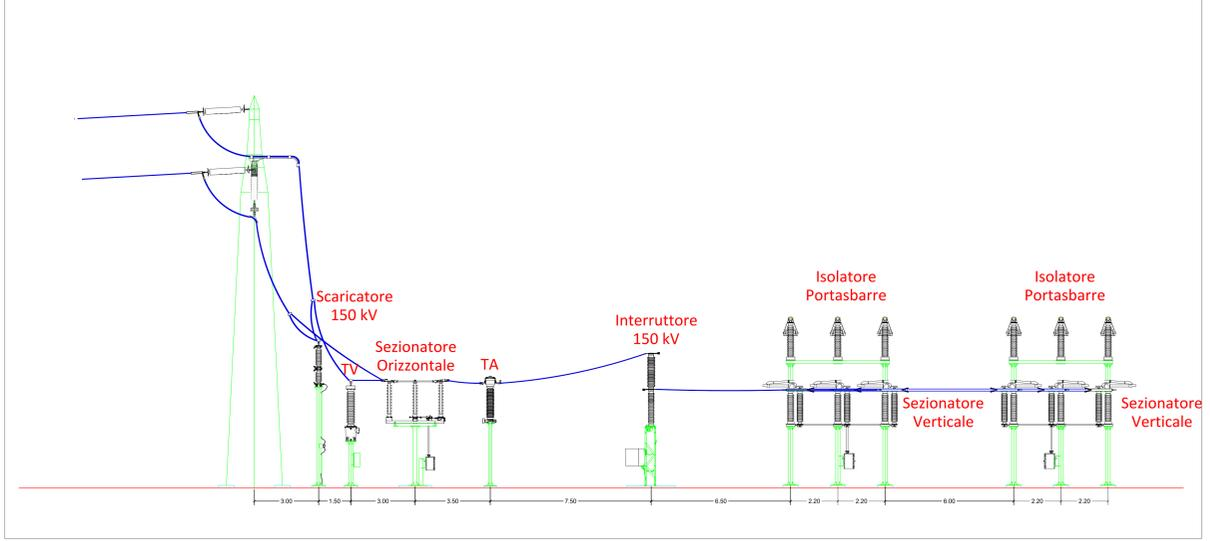
Sezione A - A \_ Linea in cavo con scaricatori
