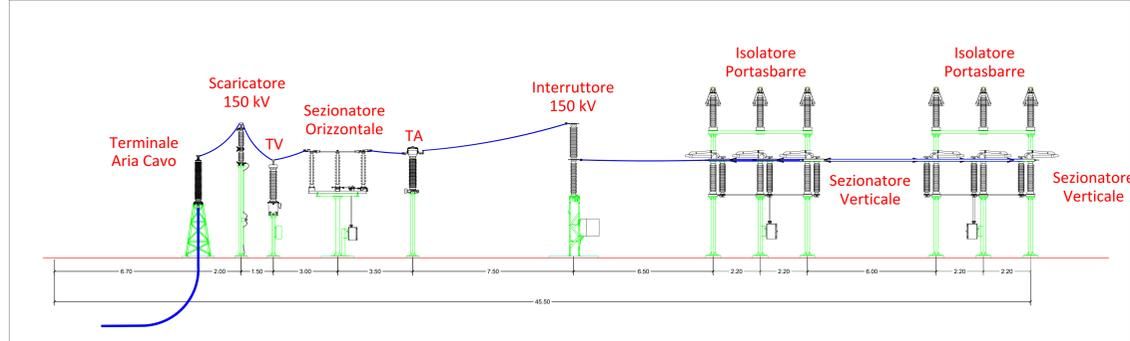
Sezione D - D \_ Parallelo modello trasverso
