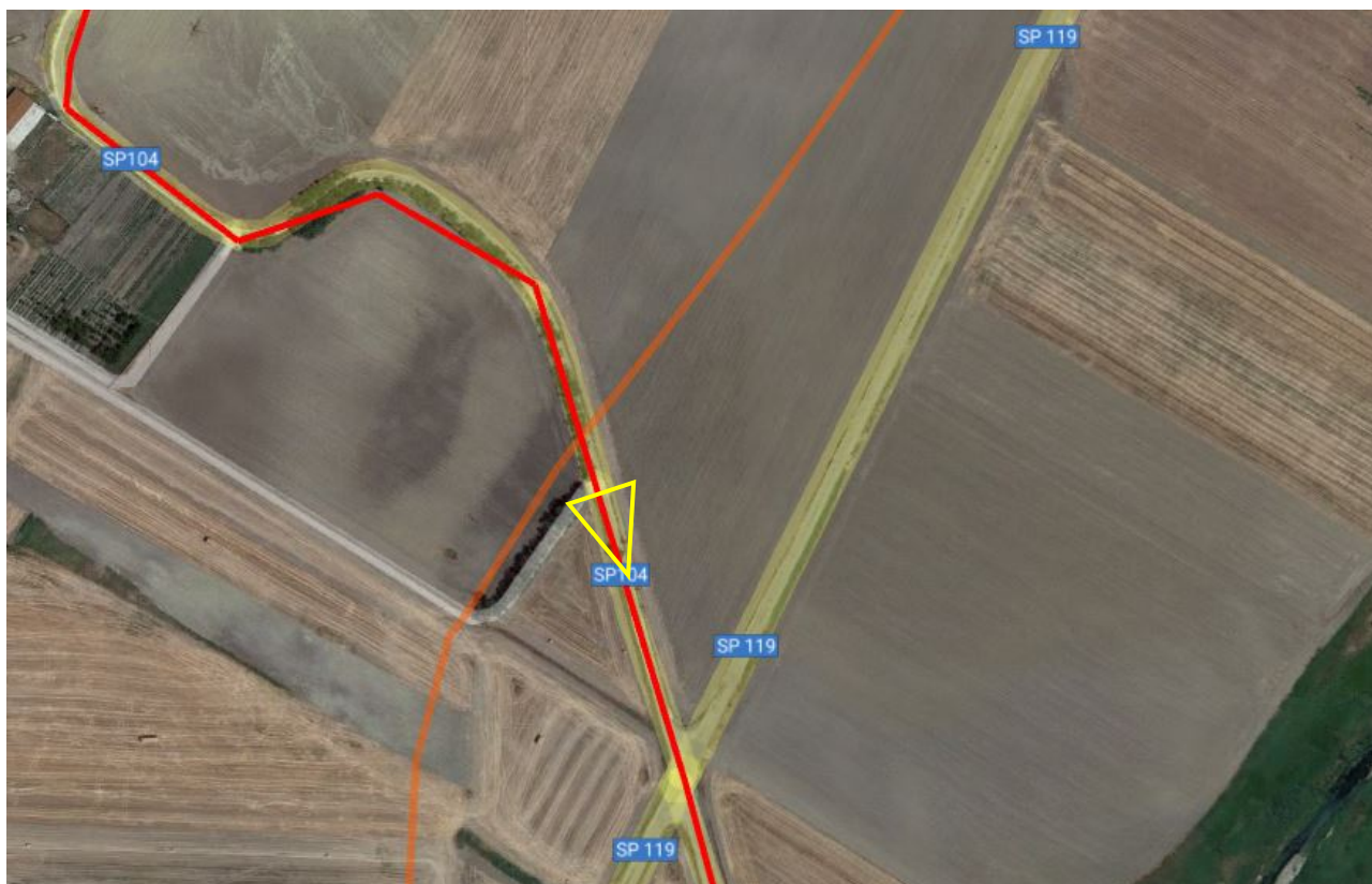
Figura 30 – INTERFERENZA 01 - Vista planimetrica su Ortofoto con in arancio il tracciato ipotetico del Tratturello Cervara – Candela - S.Agata, in rosso il tracciato del cavidotto, in giallo il punto di scatto. Dalla foto si può notare come in questo tratto il tratturo sia totalmente assimilato dai campi
