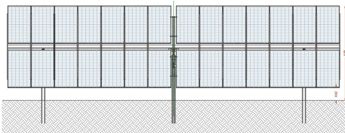
*Figura 6: Tracker 2P con Moduli FV - Vista Longitudinale*
