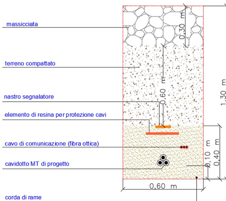
**Figura 19: Sezione Cavidotto doppia terna di cavi su Strada Bianca**
