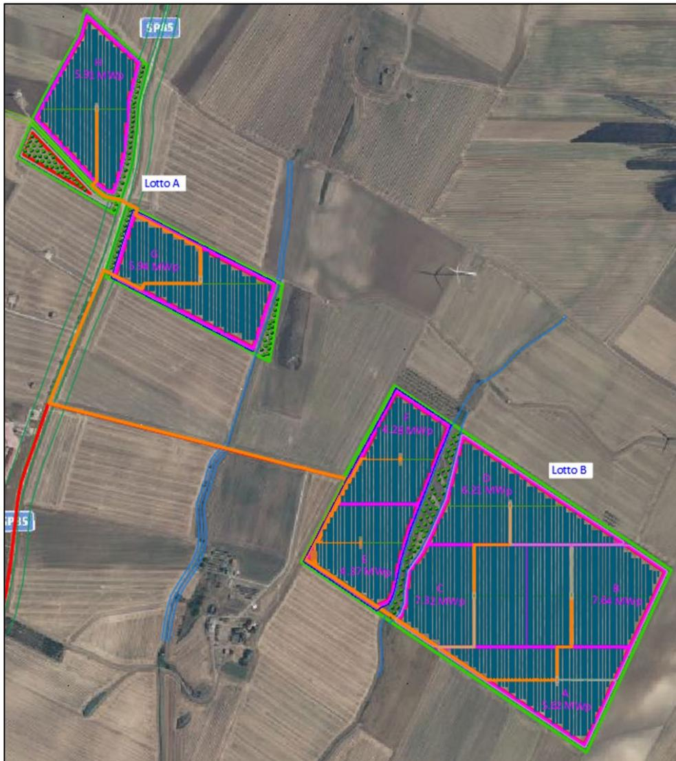
**Figura 1: Layout del campo Agro-fotovoltaico e suddivisione in sottocampi.**
