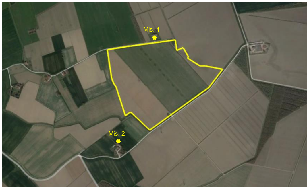
Figura 8 - Posizionamento stazioni di misura della rumorosità residua in EG Colombo – Posizioni di misura in giallo
