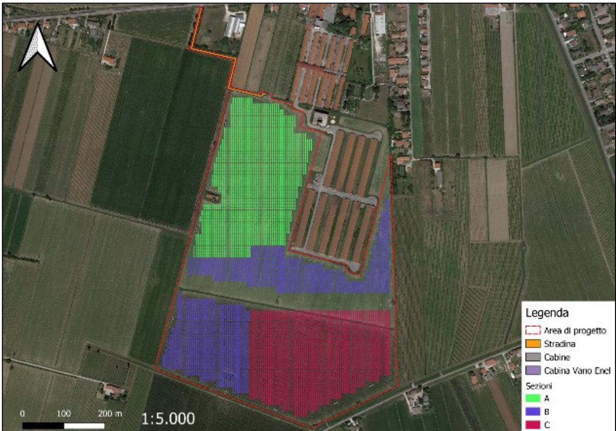
Figura 23 Inquadramento Layout Impiantistico di Progetto
