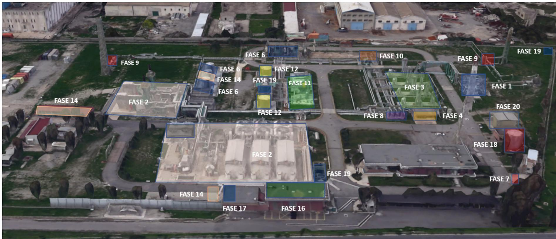
Figura 3-3: Mappa delle fasi del processo della Centrale su foto aerea 3D (Fonte: Google Earth)
