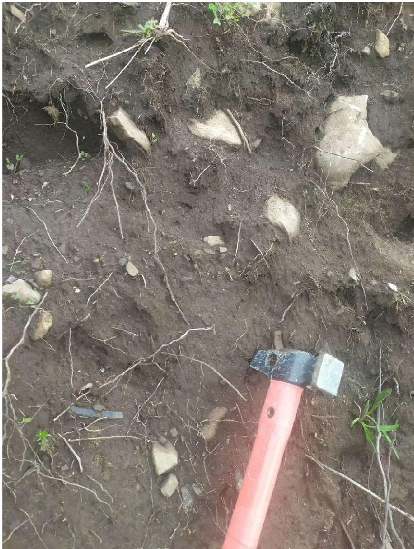
Figura 20: Profilo di pedogenizzazione nei pressi di M1\_10, con moderata presenza di scheletro. Coordinate 470251.92 m E-4447220.45 m N.
