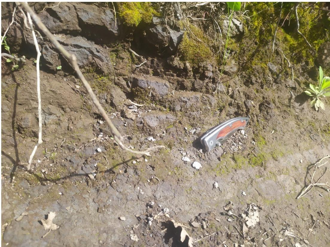
**Figura 17: Profilo di alterazione dei Basalti della Subunità di Sindia lungo la strada di accesso alla WTG M1\_12. Coordinate 470307.92 m E-4448731.99 m N. l'alterazione chimica è piuttosto profonda e ha causato la perdita della consistenza litoide dell'orizzonte superficiale in affioramento, che risulta sostanzialmente friabile.**
