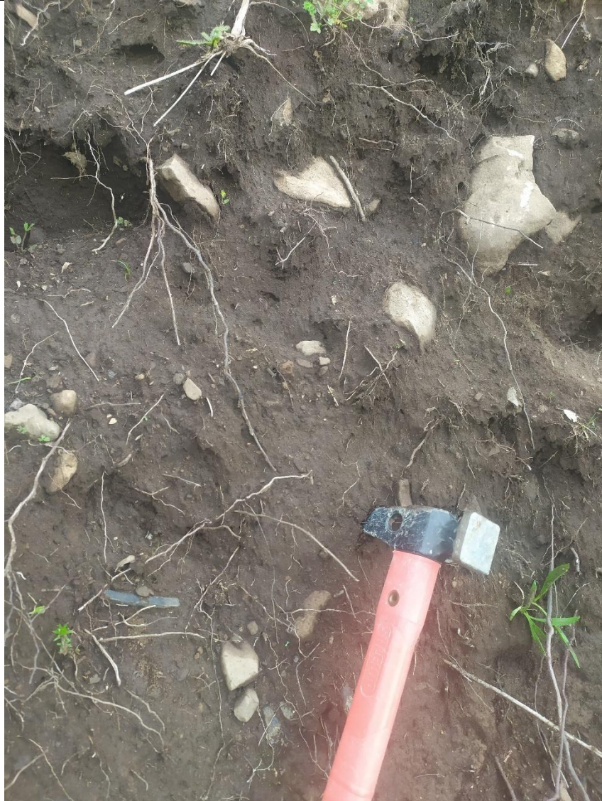
Figura 28: Profilo di pedogenizzazione nei pressi di M1_10, con moderata presenza di scheletro. Coordinate 470251.92 m E-4447220.45 m N.
