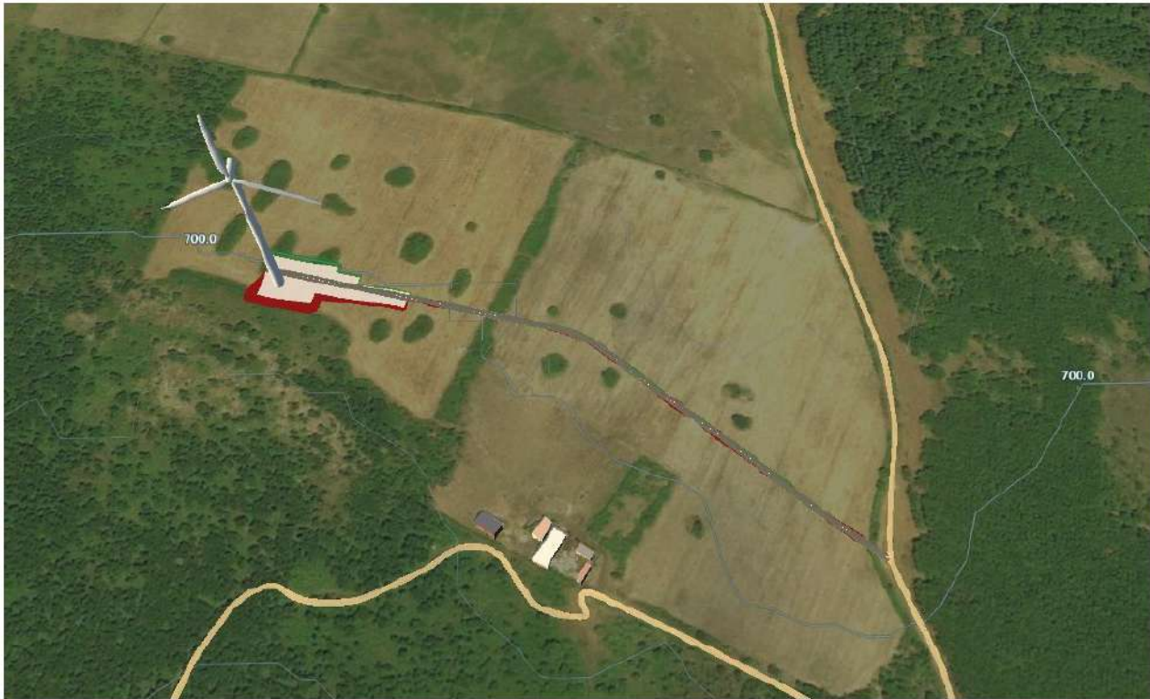
Figura 116 - Viabilità di accesso alla WTG M1_13
