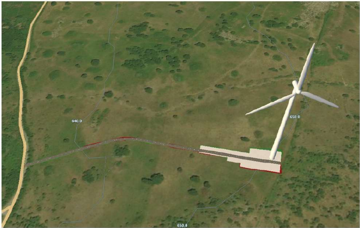
Figura 117 - Viabilità di accesso alla WTG M1_14
