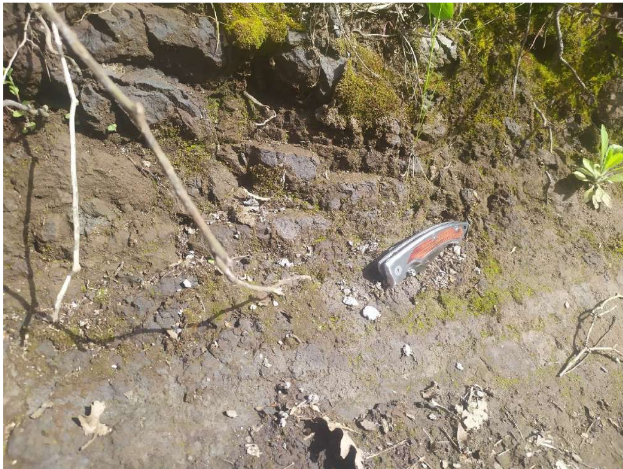
Figura 162- Profilo di alterazione dei Basalti della Subunità di Sindia lungo la strada di accesso alla WTG M1_12. Coordinate 470307.92 m E-4448731.99 m N. l'alterazione chimica è piuttosto profonda e ha causato la perdita della consistenza litoide dell'orizzonte superficiale in affioramento, che risulta sostanzialmente friabile.
