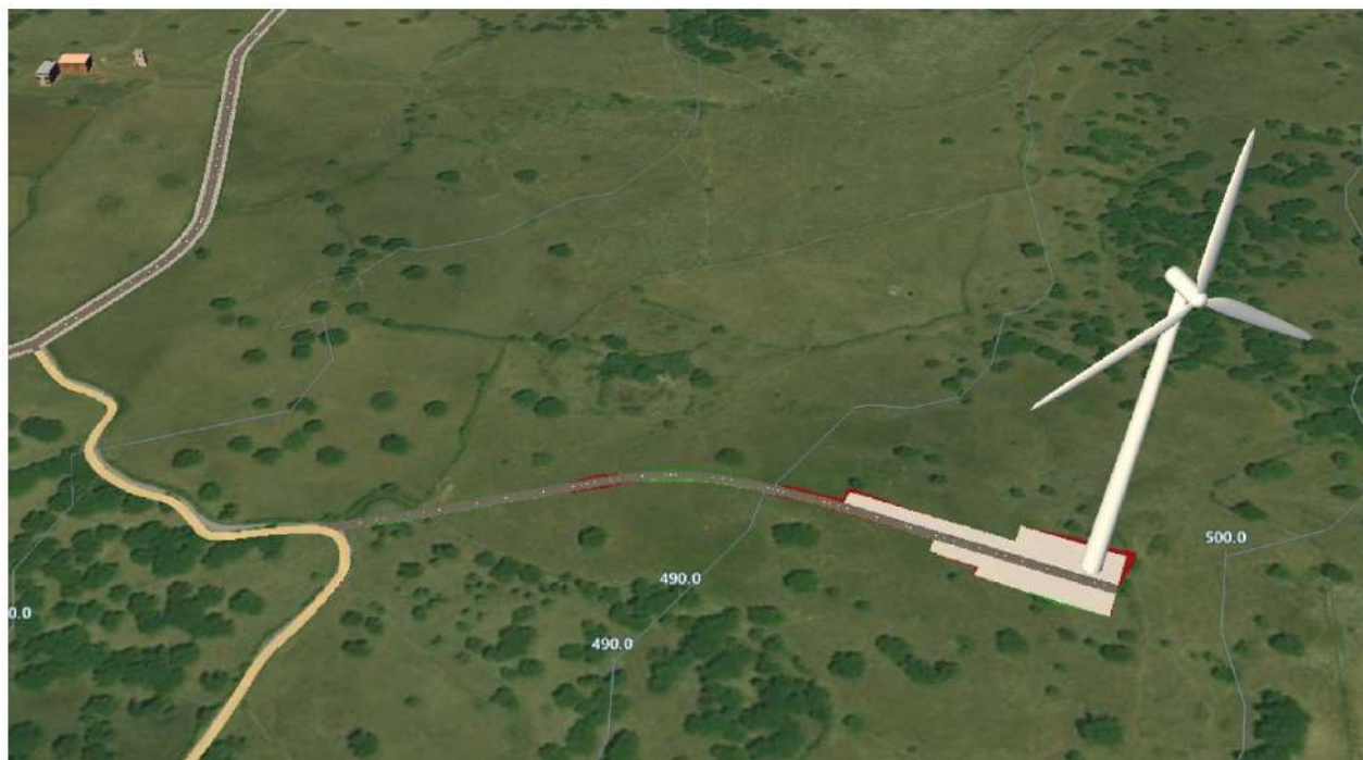
Figura 111 - Viabilità di accesso alla WTG M1_02
