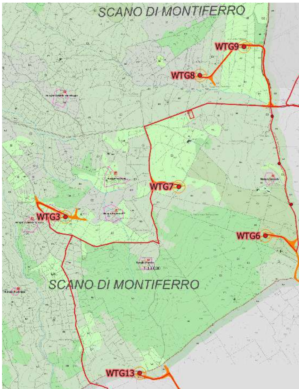
Figura 82 - Inquadramento del layout di impianto (in rosso) e della viabilità di servizio (in arancio) rispetto alle Tavole 25A e 25B "Zoning ed ambiti di tutela dei beni archeologici e architettonici", scala 1: 10.000 – Fonte: PUC del Comune di Scano di Montiferro
