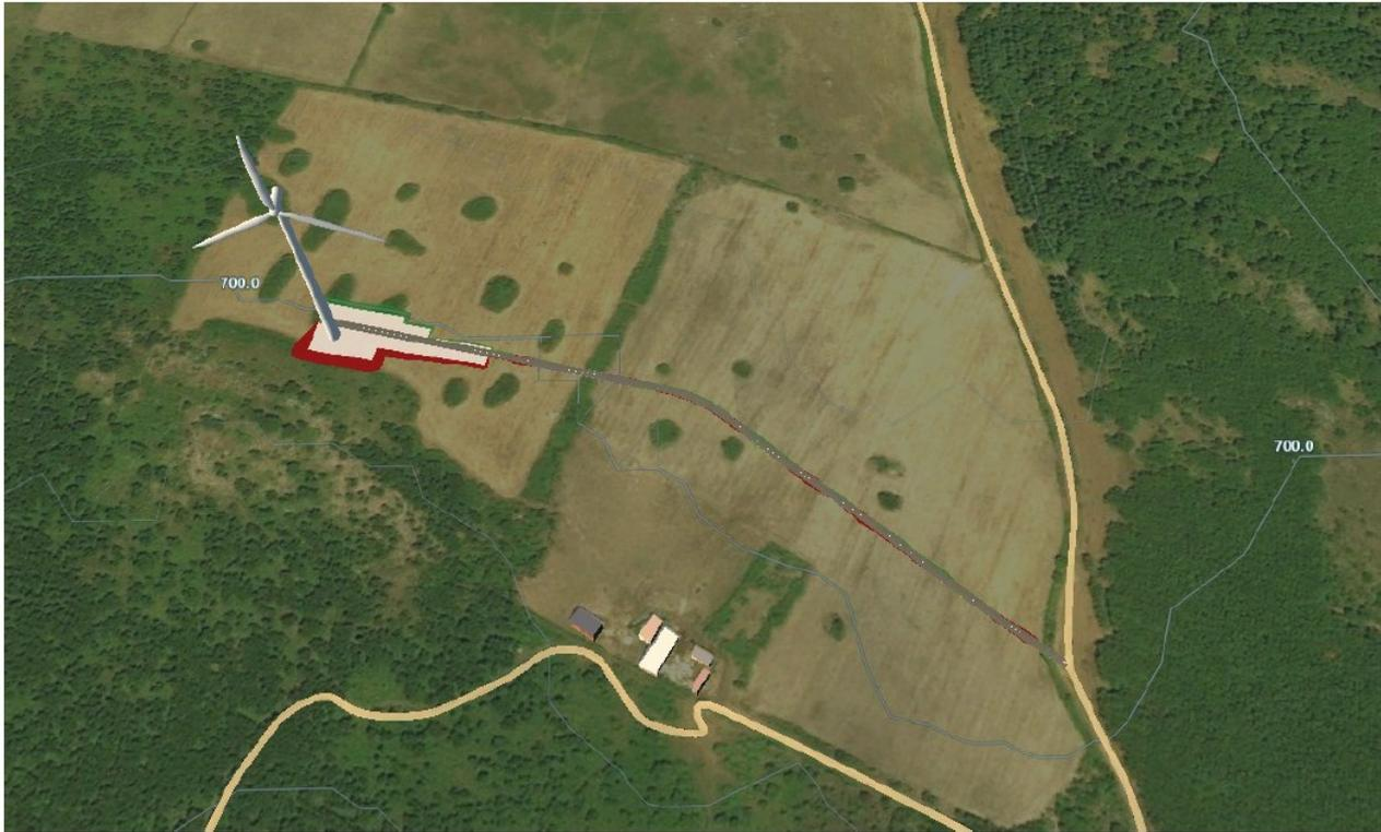
*Figura 11 - Viabilità di accesso alla WTG M1\_13*
