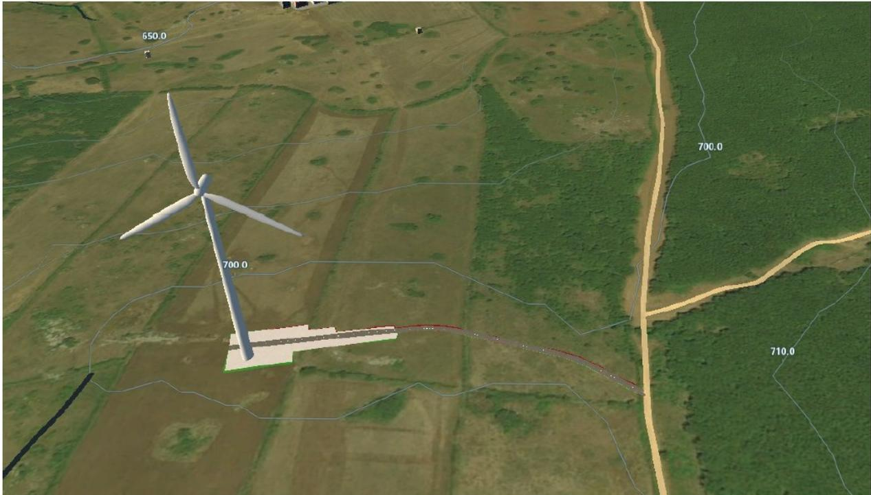
*Figura 14 - Viabilità di accesso alla WTG M1\_16*
