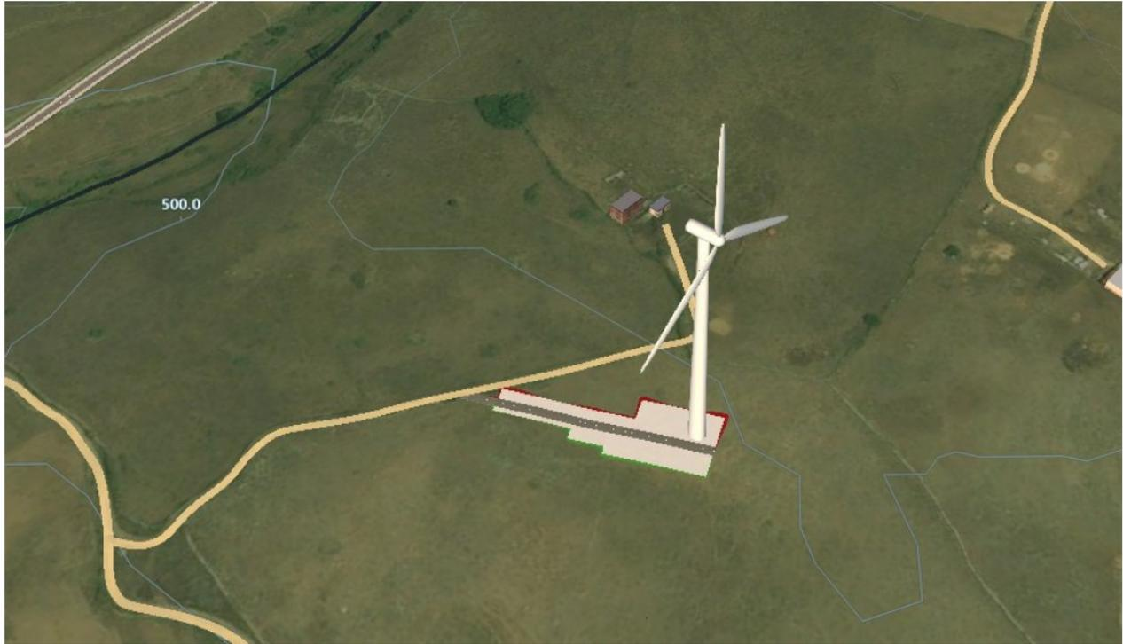
*Figura 7 - Viabilità di accesso alla WTG M1\_03*
