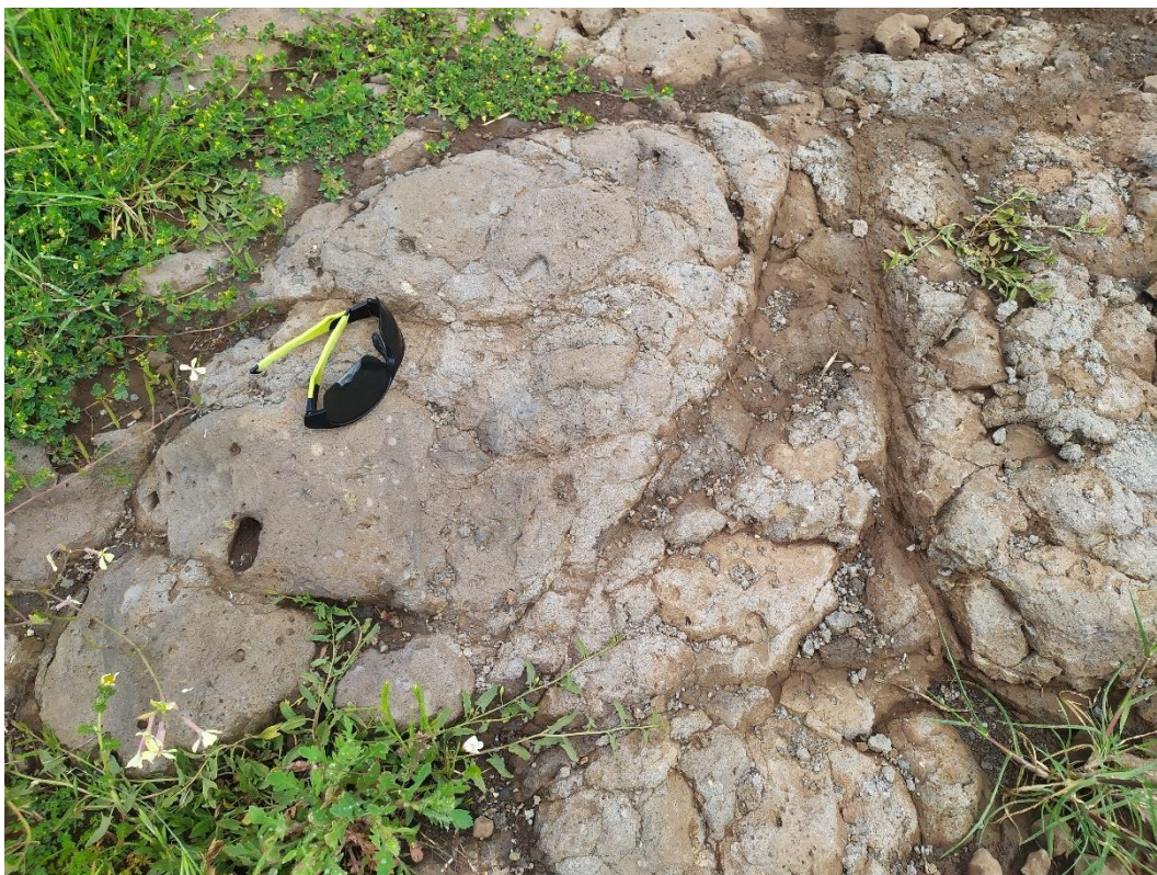
Figura 12: Trachibasalti della Subunità di Funtana di Pedro Oe, molto fratturati, parzialmente alterati, con fratturazione irregolare, posti a circa 490 m dalla WTG M2_08.
