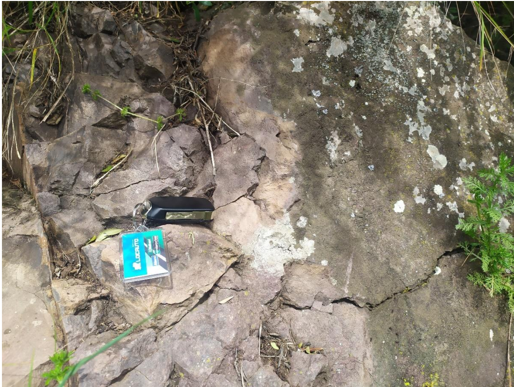
Figura 11: Basalti-trachibasalti della Subunità di Funtana di Pedro Oe, qui in parte molto fratturati, con fratturazione irregolare a circa 700 m dalla WTG M2_06.
