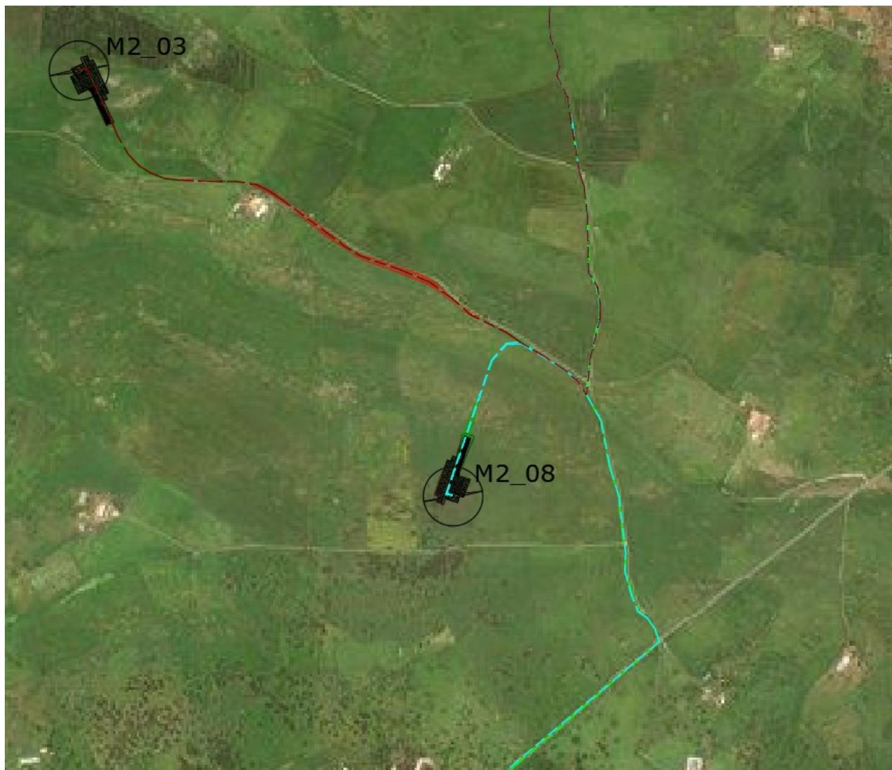
Figura 2-3: Inquadramento su ortofoto di: WTG-03, WTG-08 del progetto “Macomer 2” ed opere di connessione (Google Earth)
