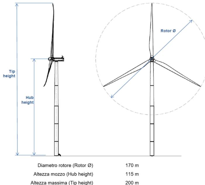
**Figura 3-3: Vista e caratteristiche dell'aerogeneratore in progetto**
