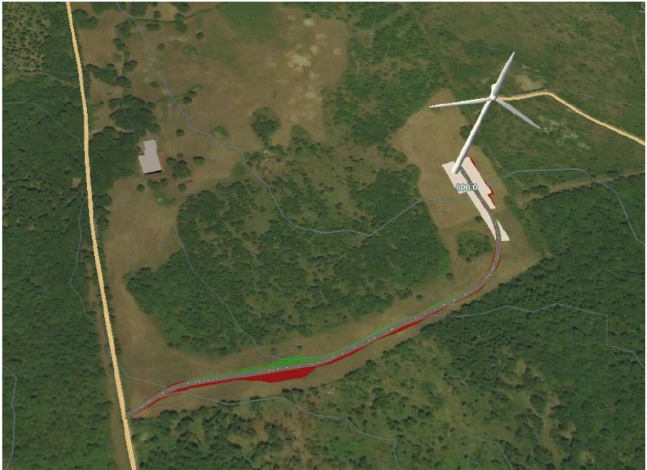
Figura 68 - Viabilità di accesso alla WTG M2_01
