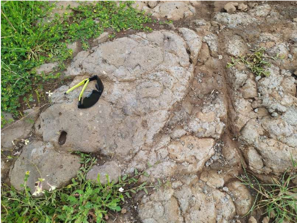
Figura 117- Trachibasalti della Subunità di Funtana di Pedro Oe, molto fratturati, parzialmente alterati, con fratturazione irregolare, posti a circa 490 m dalla WTG M2_08.
