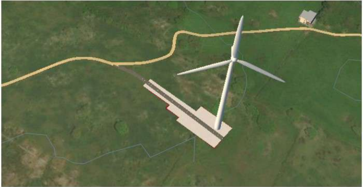
Figura 73 - Viabilità di accesso alla WTG M2_06
