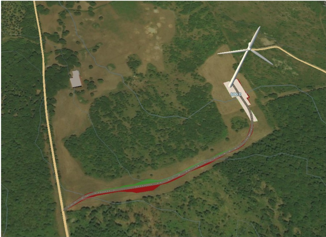
Figura 8 - Viabilità di accesso alla WTG M2_01
