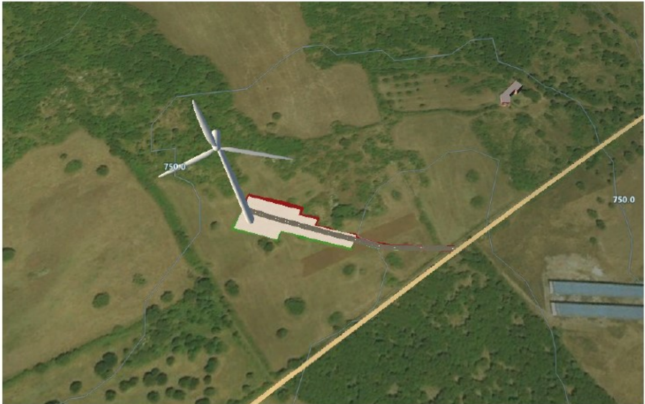
Figura 10 - Viabilità di accesso alla WTG M2_03
