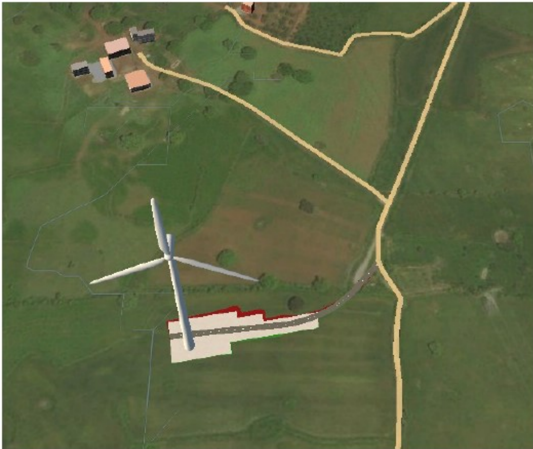
Figura 15 - Viabilità di accesso alla WTG M2_10
