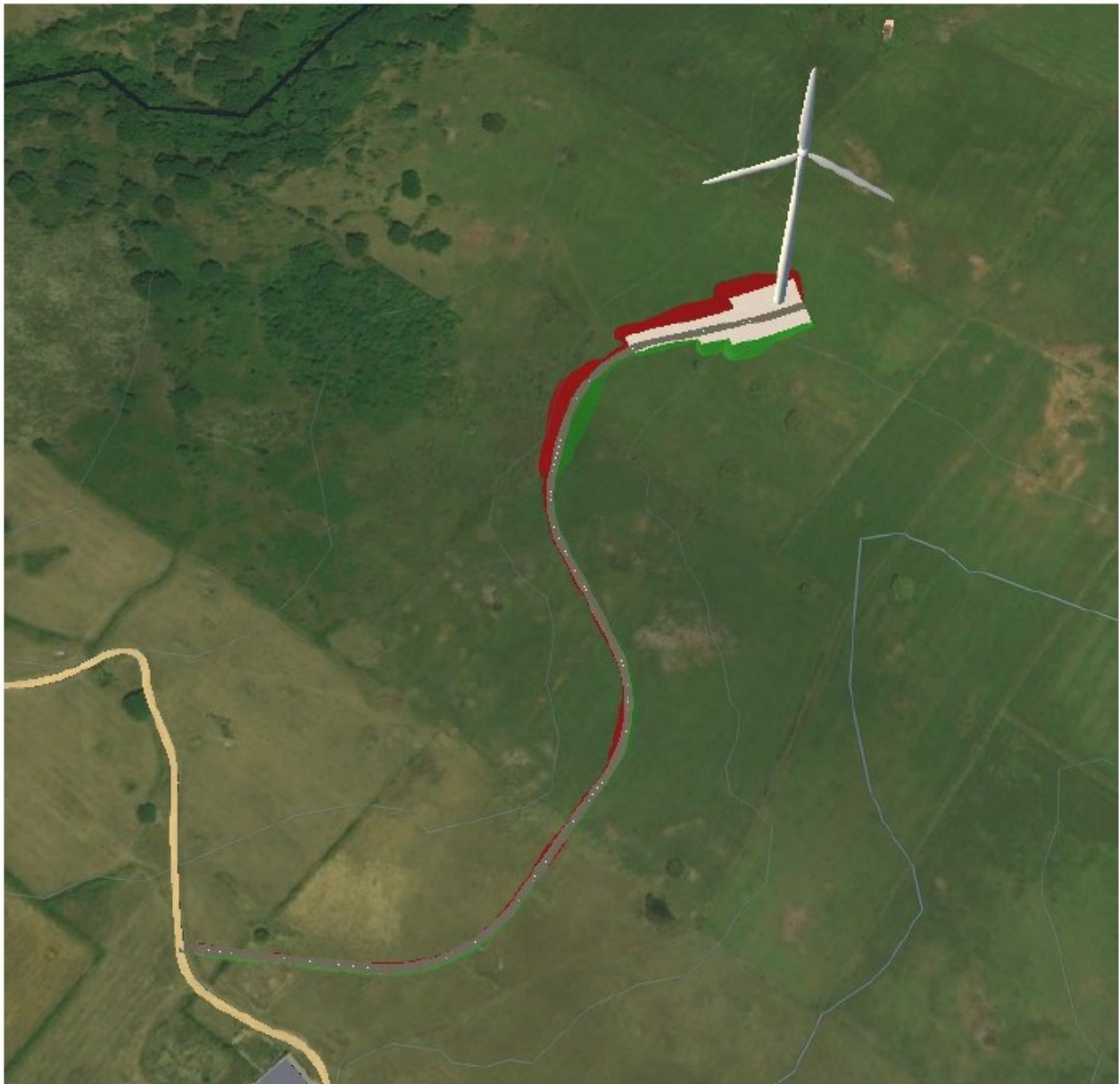
Figura 12 - Viabilità di accesso alla WTG M2_05
