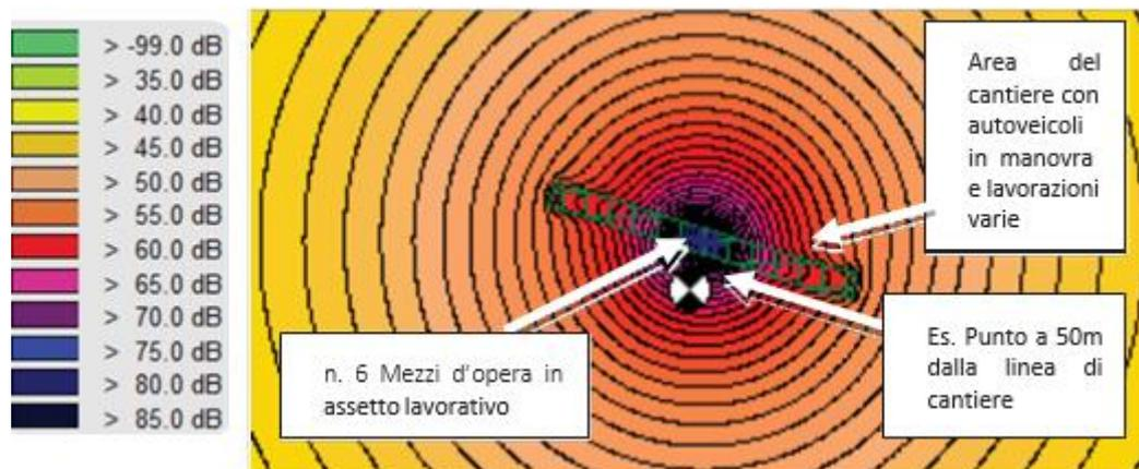
Figura 9-5: Rappresentazione grafica dell'emissione del cantiere – Curve di ISOLIVELLO dB(A)
