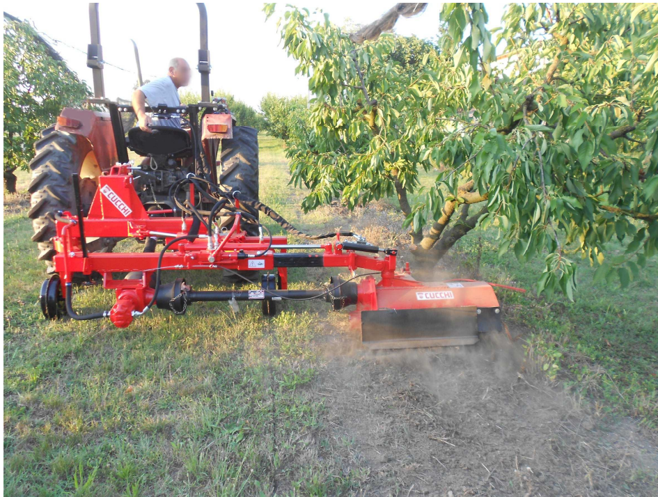
Figura 5.2: Esempio di fresatrice interceppo per le lavorazioni sulla fila (Foto: Cucchi Macchine Agricole)
