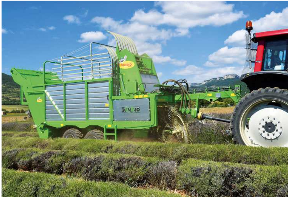
Figura 5.10: Raccogliatrice meccanica di lavanda trainata e relative specifiche tecniche (Foto: Bonino S.a.s.)
