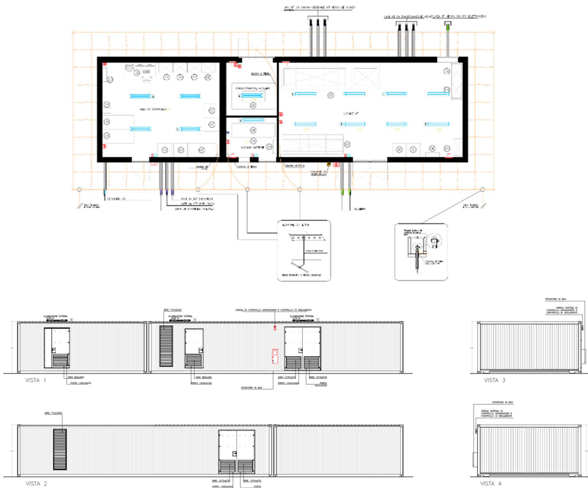
Figura 2.5: Tipologico della cabina MT
