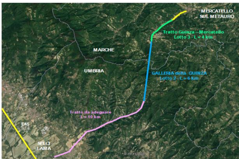
Figura 1– Suddivisione in tratti del percorso E45-Mercatello sul Metauro attraverso la Galleria della Guinza
