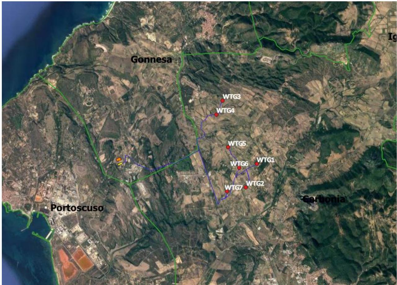
Figura 3: Inquadramento territoriale, su base ortofoto, del layout di impianto. In rosso gli aerogeneratori localizzati nel comune di Carbonia, in blu i cavidotti di connessione, in arancione e giallo la futura stazione RTN e la sottostazione multiutente di trasformazione 220/33 kV nel comune di Gonnese
