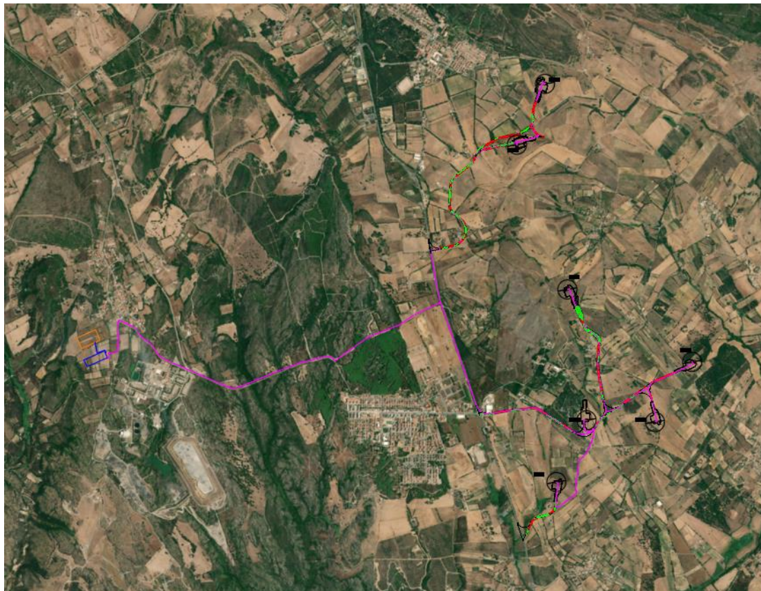
Figura 2-1: Collocazione geografica impianto eolico “Portoscuso” ed opere di connessione (aerogeneratori in bianco, cavidotti MT di impianto in rosso, Stazione Utente di trasformazione in giallo, cavidotto AT di connessione in blu) (Google Earth)
