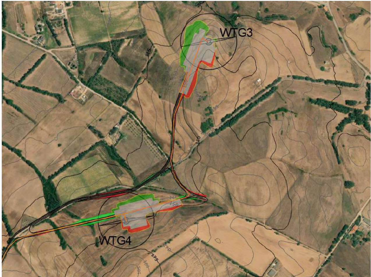
Figura 59 - Tracciato planimetrico viabilità di nuova realizzazione
