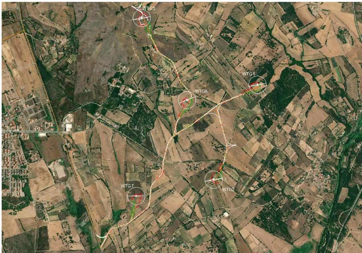
Figura 2: Inquadramento territoriale su base ortofoto del layout di progetto - in figura: WTG1, WTG2, WTG5, WTG6, WTG7
