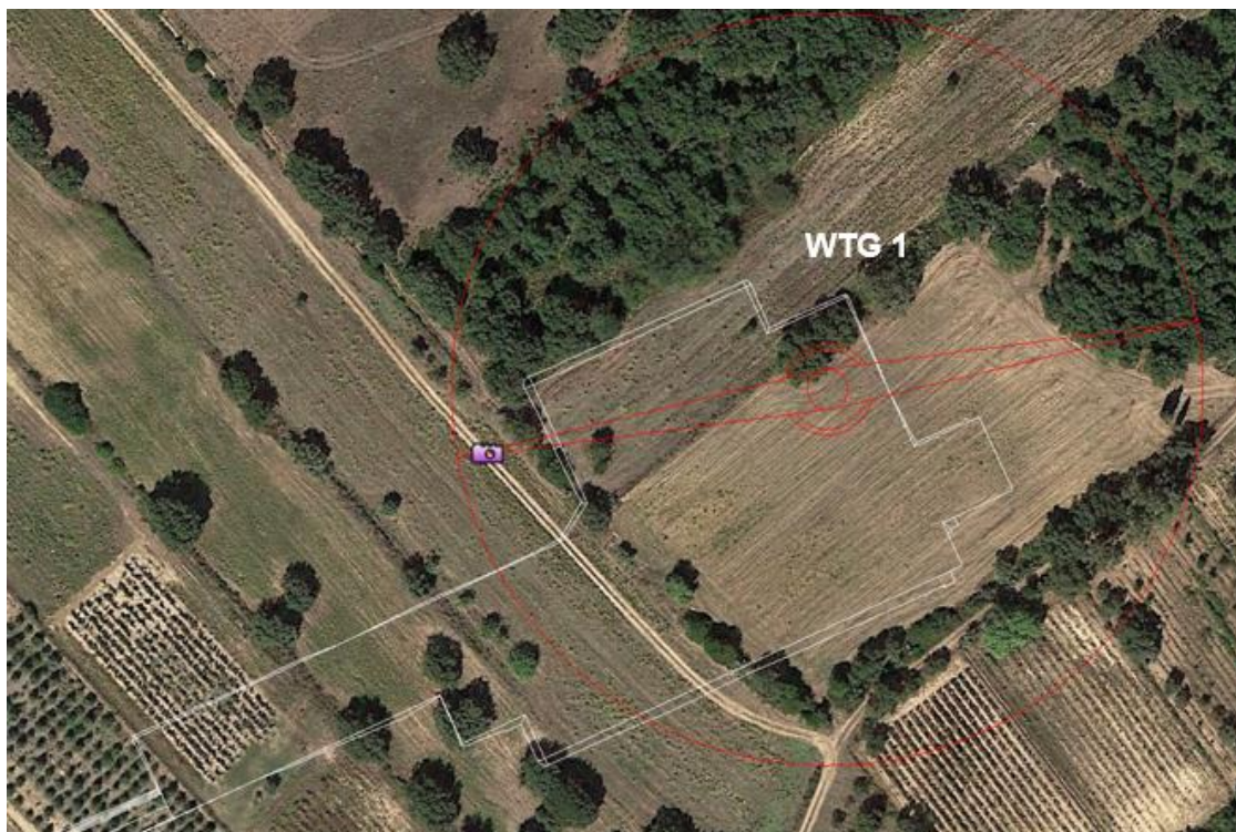
Figura 12 – Inquadramento su base satellitare delle opere relative all'installazione della WTG1 (indicata in immagine in rosso): piazzola area cantiere (in bianco) e area spazzata dell'aerogeneratore (in rosso) e relativo punto di ripresa (simbolo in viola)
