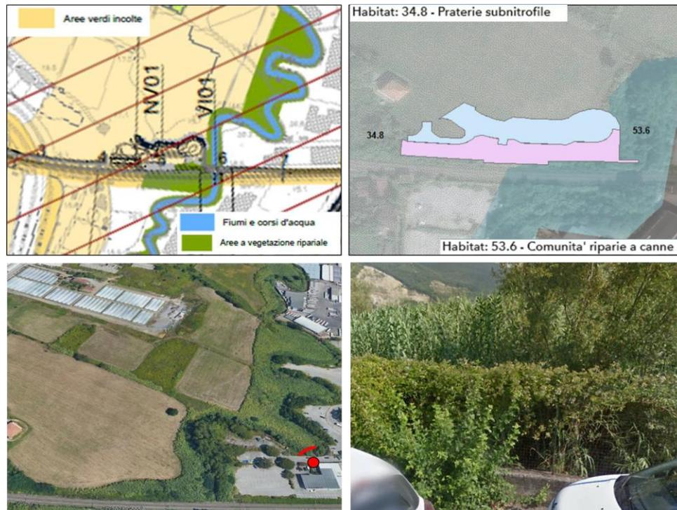
**Figura 21- Opera viaria connessa NV01 e opera connessa Fermata Ospedale in corrispondenza della pk 1+400 – 1+600: a sinistra in alto la Carta dell'utilizzazione agricola della regione Campania (2009) con modifiche dai rilievi satellitari. A destra in alto la Carta della Natura di ISPRA (2018) con l'ingombro della NV01 (in celeste) e della Fermata ospedale (in rosa). A sinistra in basso inquadramento su foto aerea con punto di vista e a destra in basso rilievo fotografico**
