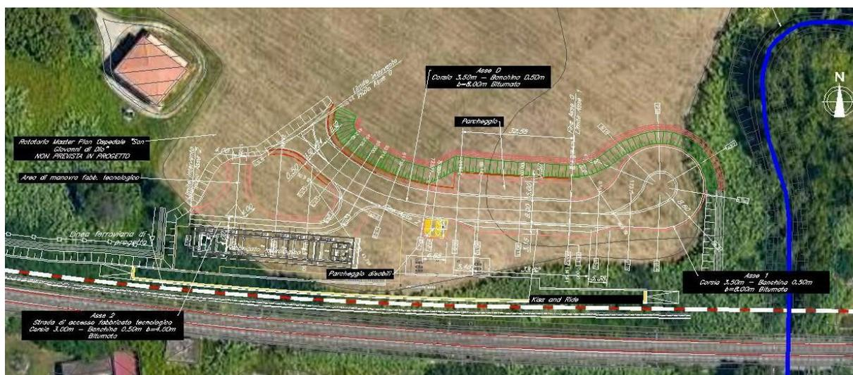
**Figura 2 – Planimetria della viabilità NV01**
