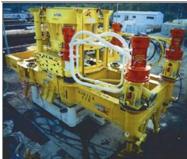
Figura 3-3: Struttura di Produzione Sottomarina
