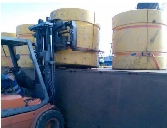
Figura 3-10: Carico delle boe di galleggiamento su 2 pianali ribaltabili con mezzo sollevatore (a sinistra) ed invio a smaltimento (a destra)
