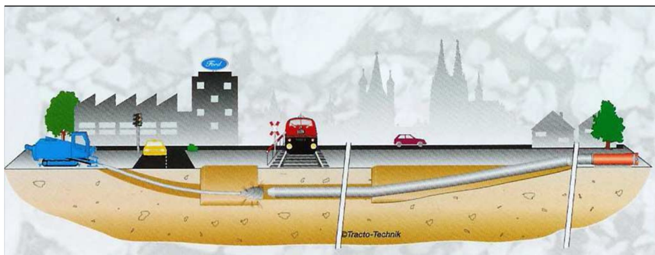
Fig. 15. Schema di principio dell'attraversamento in T.O.C.
