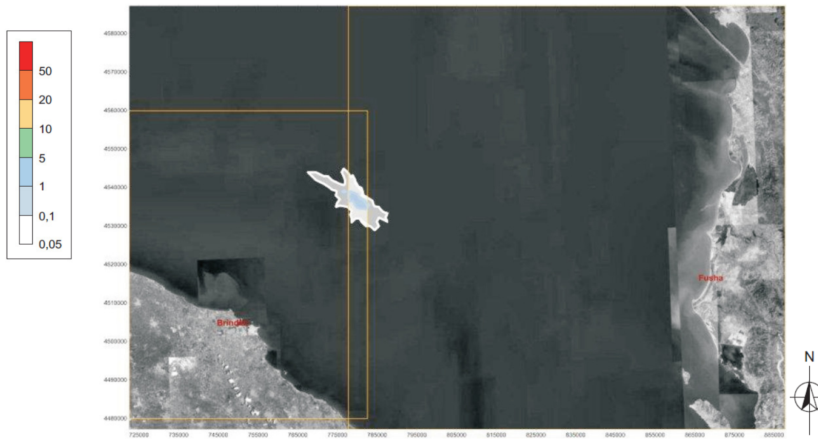
Figura 5-6: Emissioni di PTS in atmosfera – Stima delle ricadute. Concentrazioni massime giornaliere ( \mu\text{g}/\text{m}^3 )
