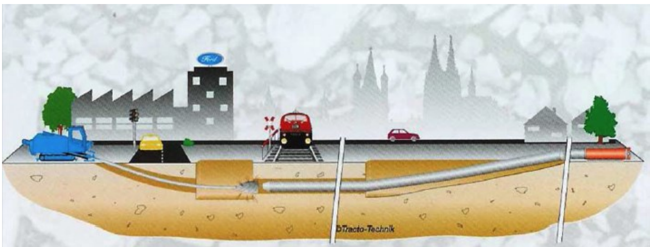
Figura 6.12. – Schema di principio dell'attraversamento in T.O.C.
