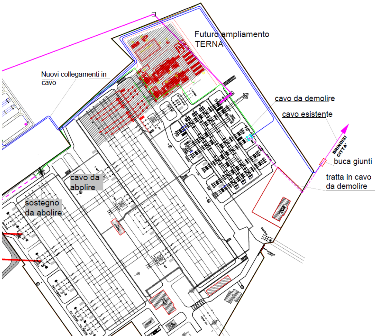
Figura 3-14 - Ampliamento Stazione Elettrica Terna 380/150 kV "Brindisi Pignicelle"
