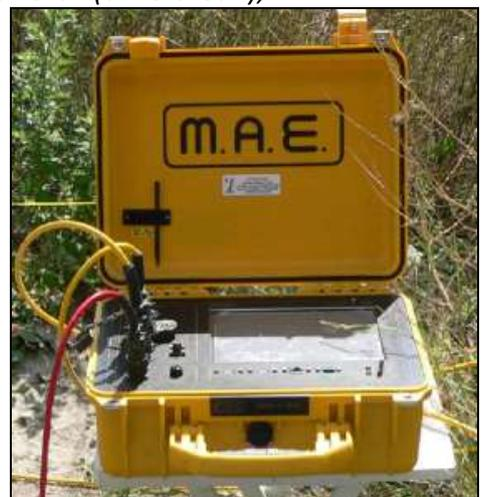
**Fig. 3: sismografo multicanale M.A.E. modello A 6000 S.**
