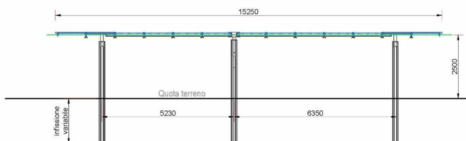
Figura 4-1 Tipologico struttura sostegno moduli – prospetto
