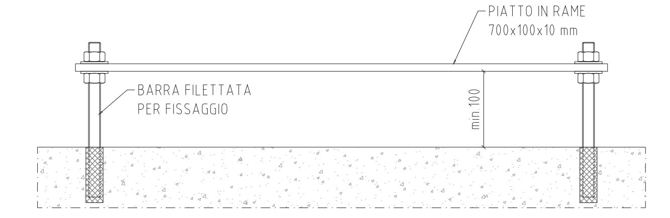
PARTICOLARE COLLETTORE M.A.T. Scala 1:5 (mm)
