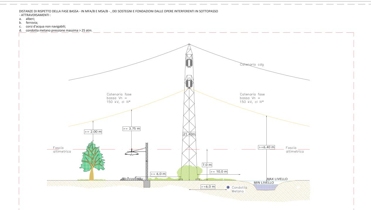
DISTANZE DI RISPETTO DELLA FASE BASSA - IN MFA/B E MSA/B - , DEI SOSTEGNI E FONDAZIONI DALLE OPERE INTERFERENTI IN SOTTOPASSO
